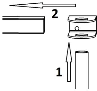
Для проведения сборки понадобятся гаечные ключи 17мм, 19мм и 22мм.
