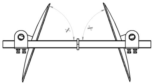
Чтобы окуучник не тянуло в бок, установите диски на одинаковый угол относительно штанги окуучника, затяните крепежные болты хомутов.
