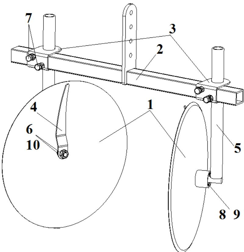
Окучник дисковый **VALRUS «Профи»** оснащён дисками диаметром 430 мм, толщиной 4 мм, по краю диск заточен для улучшения качества работ и уменьшения трудозатрат. Каждый диск окучника посажен на два подшипника качения, что многократно повышает срок эксплуатации по сравнению с пластиковыми втулками других производителей.
